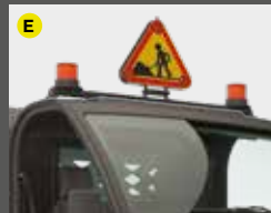
Rampe toit + triangle AK5
